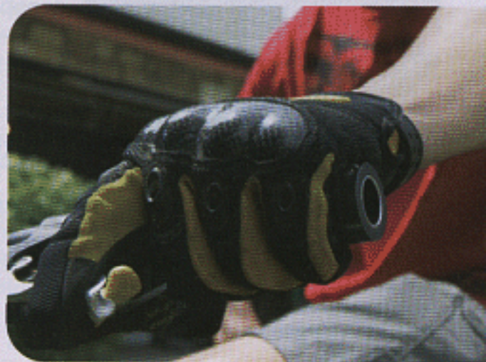
Палец должен оставаться на конце тормозной ручки, а угол ее наклона должен соответствовать углу наклона запястья.
